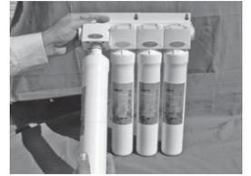
Paso D – Asegúrese de quitar la tapa del nuevo filtro de reemplazo. Inserte el nuevo cartucho de filtro en el cabezal y gírelo en el sentido de las agujas del reloj 1/4 de vuelta hasta que se detenga. Regrese el cartucho a la posición vertical.
