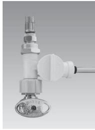
Paso B – Conecte el tubo verde del módulo de filtro al Adapt-A-Valve™ que está conectado al ángulo de parada válvula. Deje suficiente tubo para que no se enrosque y corte el tubo a la longitud deseada.
